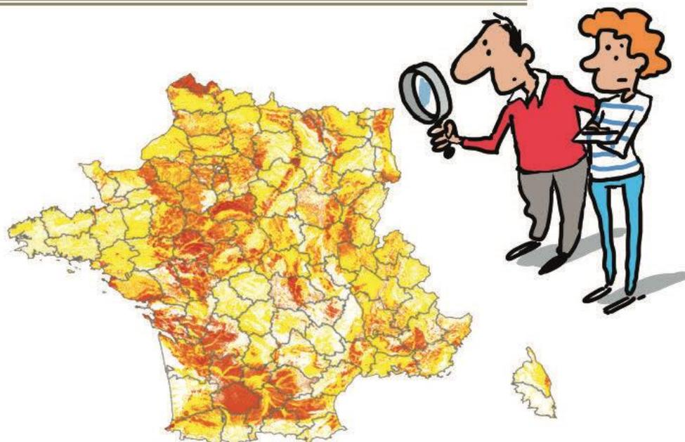
Exposition: Cette **cartographie** définit différentes zones en fonction de leur degré d'exposition au phénomène de mouvement de terrain différentiel consécutif à la sécheresse et à la réhydratation des sols argileux.
