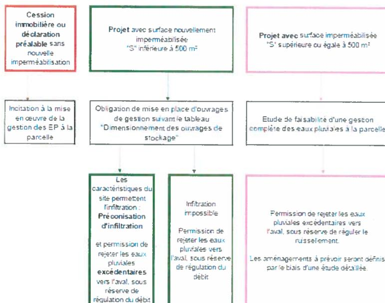
Ainsi, dès une imperméabilisation de moins de 500 m<sup>2</sup>, une gestion des eaux pluviales doit être prévue, par infiltration si possible, avec un éventuel rejet des eaux pluviales excédentaires sous réserve de régulation de débit.
